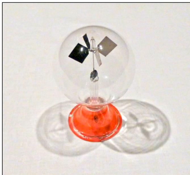
Radiometro di Crookes (inv. 529 Armadio D3)
